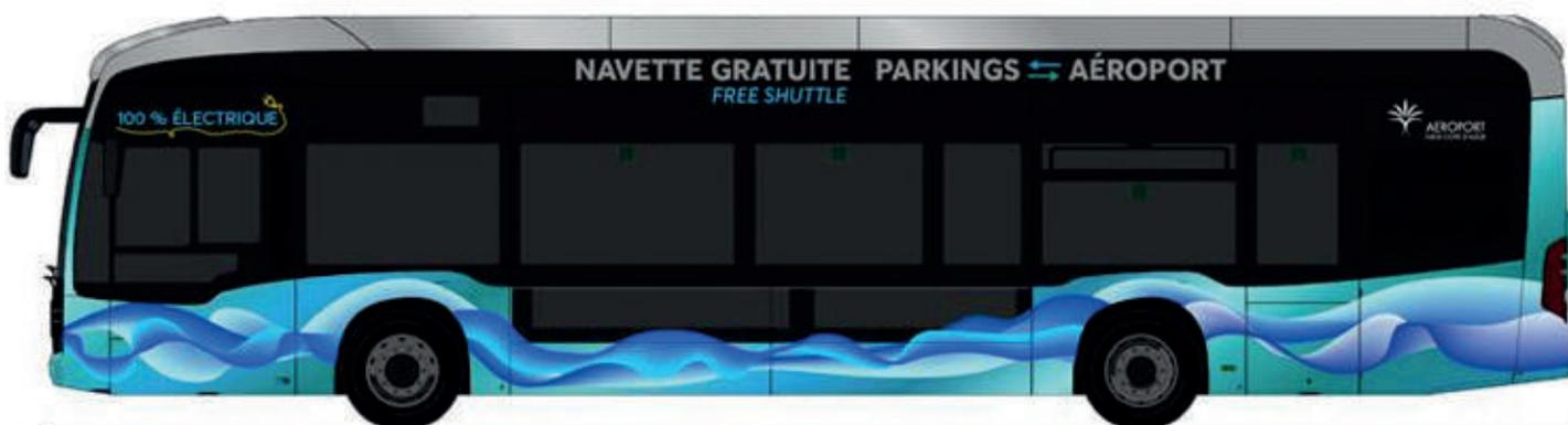
Dotés d'une autonomie de 160 km (ou de 8 heures), cette flotte permettra la circulation en simultanée et en continu de 2 navettes bénéficiant en outre d'un procédé de rechargement en continu par récupération de l'énergie cinétique.
